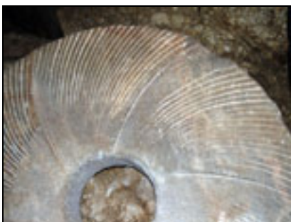
Rillen im Mahlstein, um das gemahlene Korn gegen aussen zu bringen
